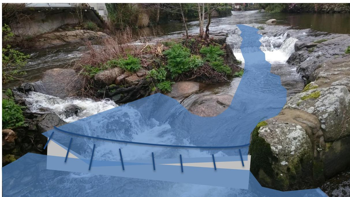
Les dimensions du prébarrage préconisées sont identiques à l'ouverture hydraulique du menhir (gros-bloc) qui le précède. La pente hydraulique de 4 % se prolongera jusqu'à cet ouvrage.
